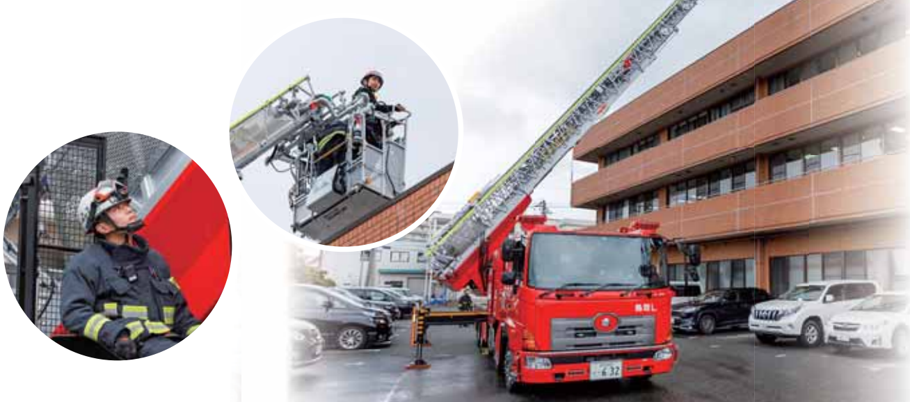
約40mの高さまで伸びるはしご車。マンションやホテルなど高所の火災で活躍する
