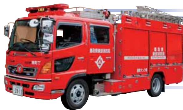
消防車には、ポンプ車、化学車、指揮車などの種類があり、水を貯えられるタンク車(写真)は現場で主力となる
