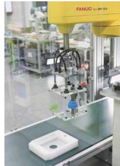
【高速型スカラロボット】 コンベアーの早さと同じ速度で製品を追いかけつつかみとる。高速かつ高精度な動作が可能
