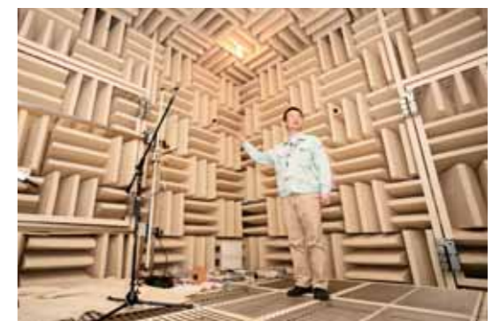
【無響室】 自分の声さえも響かない部屋。掃除機などの電化製品の音を正確に測定できる
