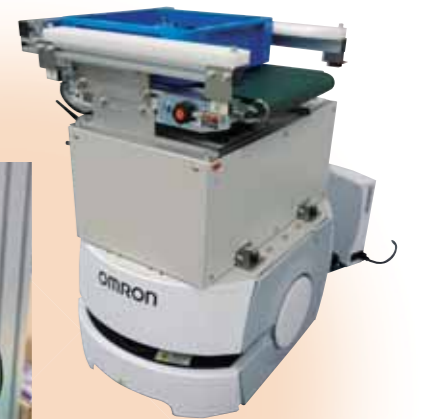
【自動搬送ロボット】 自動地図作成などによって自立して動く。障害物はすばやく察知して避ける
