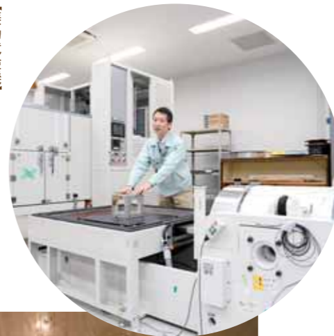
【振動試験機】 振動や温度、湿度など、さまざまな負荷をかける実験の解説をする高橋さん
