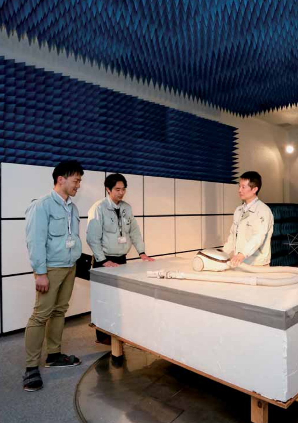
【電波暗室】 電磁波の基準は厳しいため、さまざまな企業が訪れ、電化製品を台の上に置いて測定する
