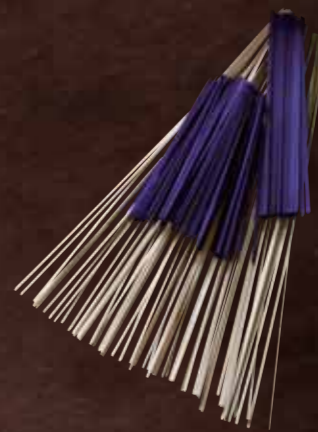
竹を細くさいて、穴をあけるなど、数々の工程を経た親骨と子骨。何本も組み合わせ、傘の骨組みになる
