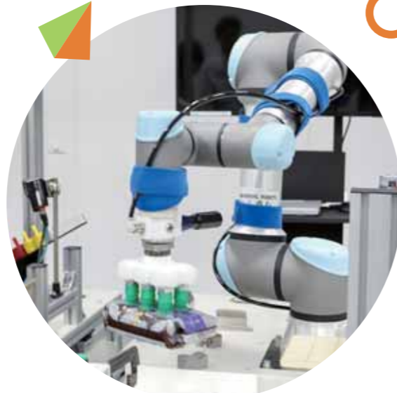
【高精度型協働ロボット】 部品挿入や柔らかい製品の箱詰め作業などを人と一緒にこなすことができる
