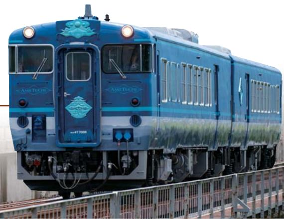
※キハ47形=1977年~88年までに製造されたキハ40系気動車のうち、暖地向けに製造した車両
