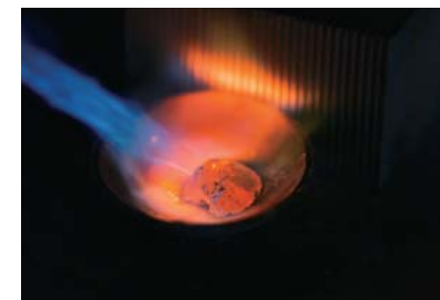
銀細工をつくる最初の工程。 銀の粒をガスバーナーで ゆっくり溶かす
