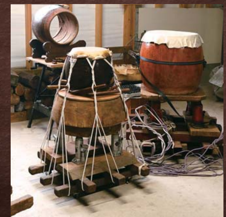
なめした新しい皮をロープで引っ張って型をつける作業。修理の工程は全て手作業で、ひと張り仕上げるまでに約2カ月かかるという
