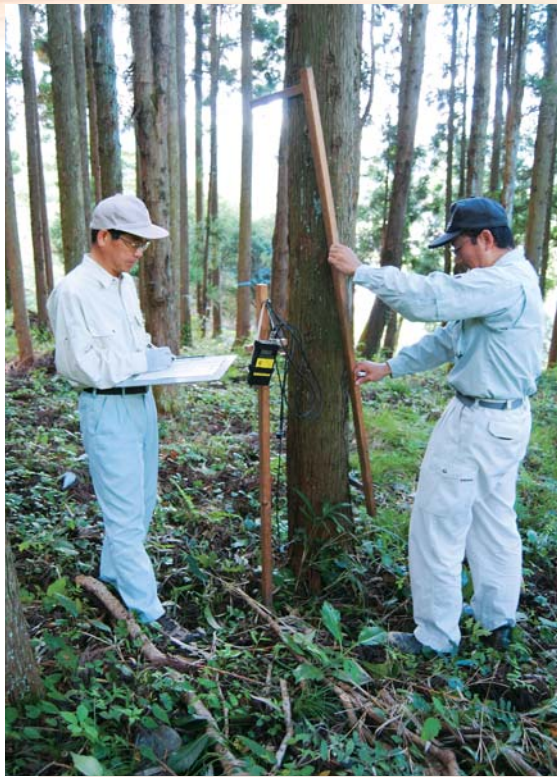
音が木を伝わる時間の差によって強い杉を見極める調査。調査方法は研究員のひらめきから生まれたという(写真提供:鳥取県林業試験場)
