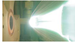
物質が燃える時には特有の色を発しながら燃える。原料の比率を変えることで、多彩なカラーの流れ星が作れるという (写真提供:株式会社ALE)
