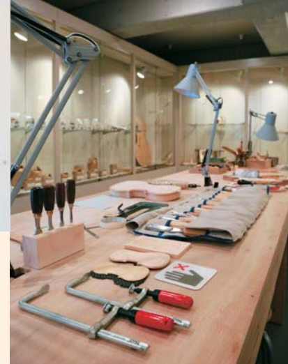
バイオリンを作る道具がズラリ。パーツごとに使う道具が違うため、何十種類にもなる(1階展示室)
